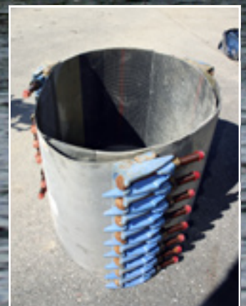
En av de seks skjøtemuffene som ble bruk til reparasjonen.
